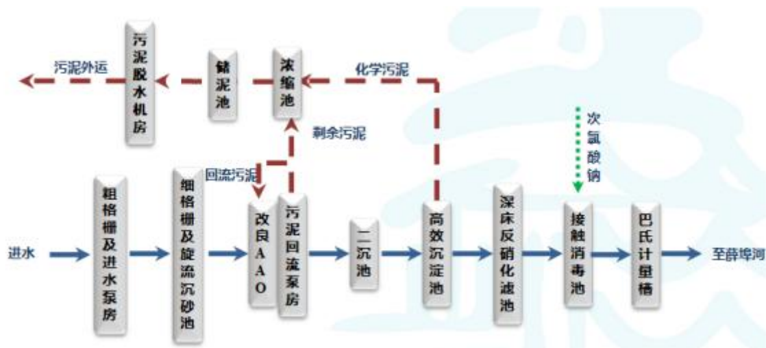
图4-1 污水处理厂工艺图
